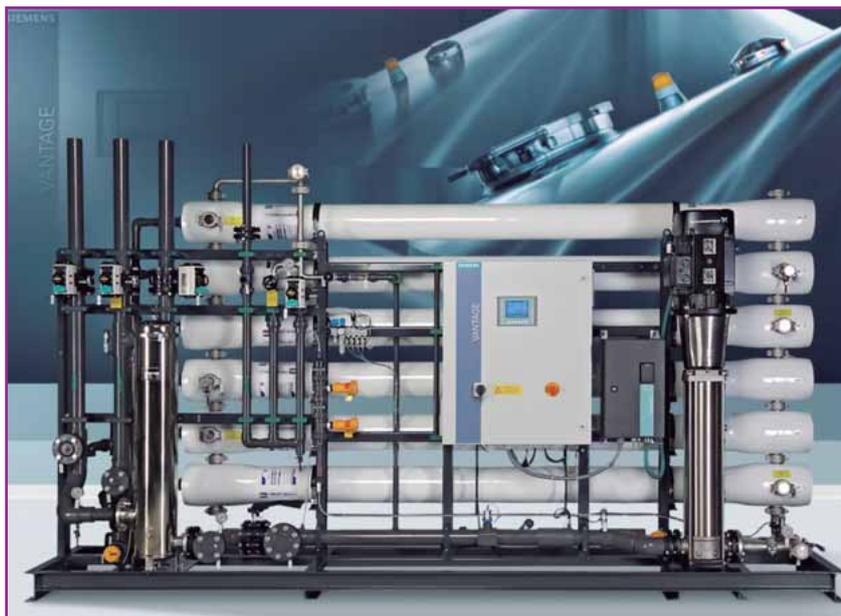
Bastidor de Osmosis Inversa, Vantage® M83, con capacidad para caudales de agua producto desde 6 m<sup>3</sup>/h a 20 m<sup>3</sup>/h y opera con fluxes desde 20 l/mh a 30 l/mh y recuperaciones del 60% al 80%.
